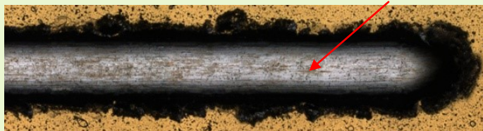
スクラッチ試験によるTiNコーティング膜の密着性比較 (基材SKH51、100N負荷時の圧痕)
