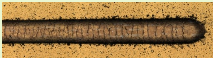
スクラッチ試験によるTiNコーティング膜の密着性比較 (基材SKH51、100N負荷時の圧痕)
